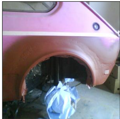
Brantho Korrux nitrofest RAL 3009 als erste Schicht Rostschutzgrund nach Schweißarbeiten mit der Grundierpistole aufgetragen
