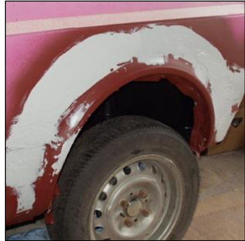
Epoxy-Spachtel auf „nitrofest“ aufgetragen. Schleifbar nach ca. 6 Stunden
