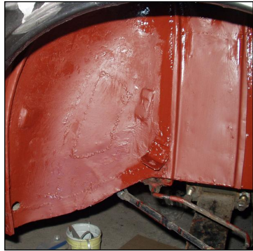
Brantho Korrux nitrofest RAL 3009 mit dem Pinsel aufgetragen, bereits leicht angetrocknet
