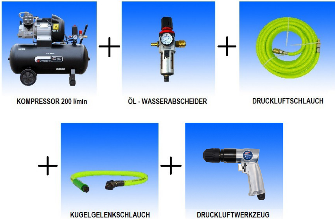
ABB: 1 ANSCHLUSSSCHEMA DRUCKLUFTWERKZEUG
